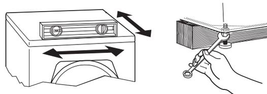
Si la laveuse est placée contre un mur, on doit l'écartier légèrement du mur avant de l'incliner vers l'arrière. Si la laveuse n'est pas d'aplomb, soulever l'avant de la laveuse avec une cale de bois et ajuster la position des pieds selon le besoin; soulever ensuite l'arrière de la laveuse et ajuster la longueur des pieds selon le besoin. Répéter ces opérations jusqu'à l'obtention d'un aplomb correct de la laveuse (utiliser un niveau).
